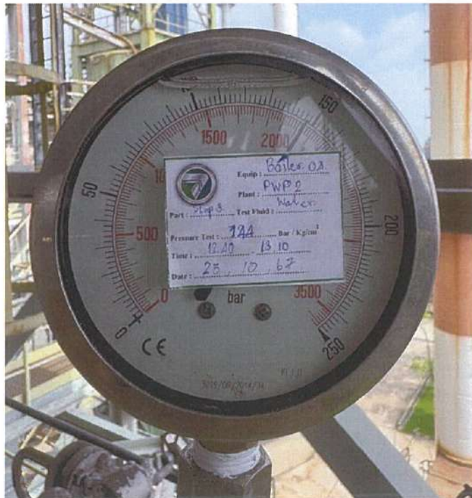
ภาพถ่ายแสดงขณะทำการทดสอบความดันในการตรวจทดสอบหม้อน้ำ
